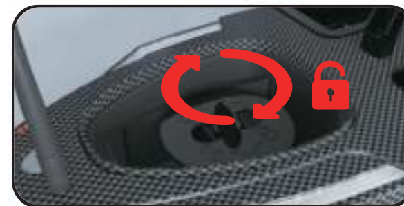
Wyjmowanie i instalacja akumulatora Obróć zgodnie z ruchem wskazówek zegara, aby otworzyć i wyjąć akumulator, wciśnij uchwyt na miejsce i obróć przeciwnie do ruchu wskazówek zegara, aby go zabezpieczyć.
